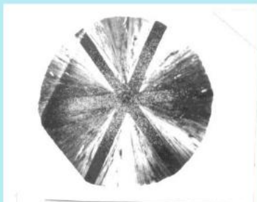
照片1 三氯氢硅多晶棒 横截面的晶粒分布照
